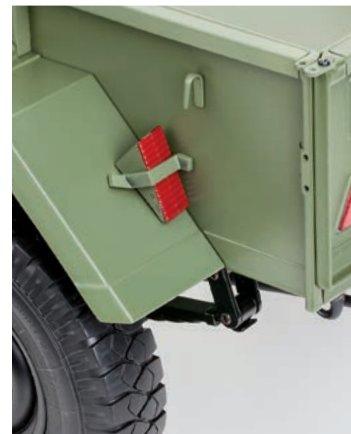
Шаг 4. Зафиксируйте собранный ранее противооткатный упор между кронштейном и левым крылом прицепа. Упор должен держаться за счет трения.
