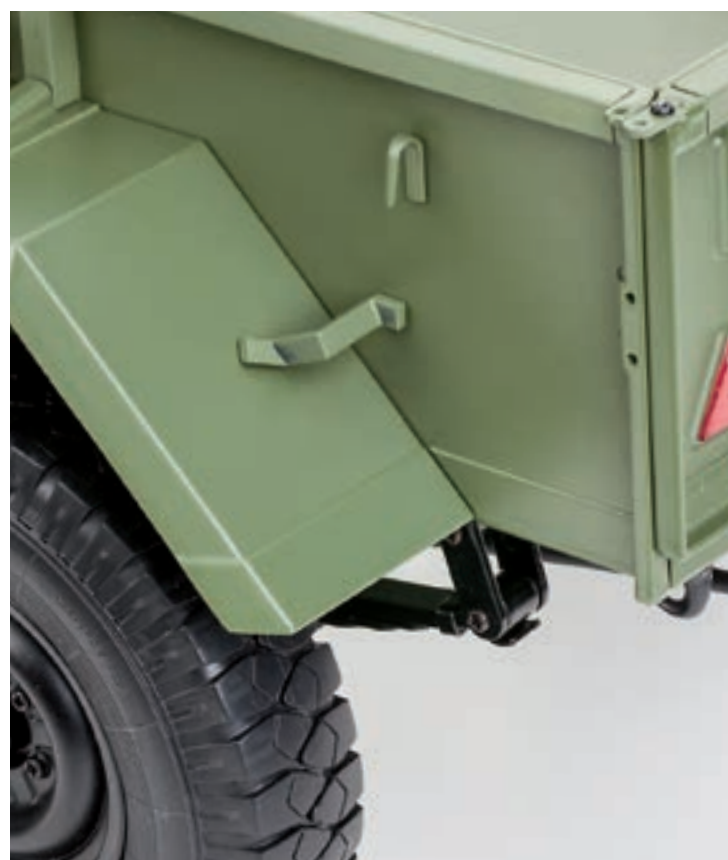
Шаг 3. В задней части установленного ранее крыла разместите кронштейн противооткатного упора. Обратите внимание: изогнутая часть кронштейна устанавливается на крыло. Совместите крепежные элементы деталей и закрепите кронштейн на прицепе.
